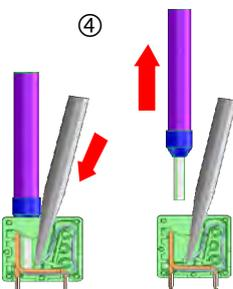
1. Introduire le tournevis dans l'ouverture carrée sans exercer de pression sur le côté afin d'ouvrir les logements de borne. Lorsque le logement de borne est ouvert retirer le conducteur.
